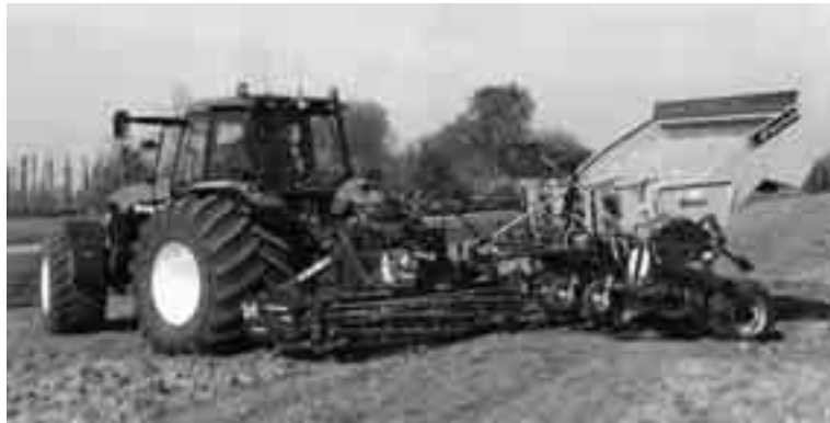
Fig. 5.2 Grondbewerking en poten in één werkgang
