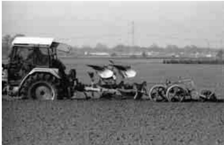
Fig. 5.1 Ploegen met een vorenpakkercombinatie
